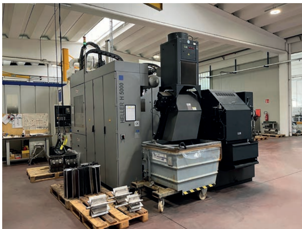
Een van de geavanceerde vijfassige CNC-freesmachines waarmee VDL Olocco zelf verschillende onderdelen voor haar sluisen produceert.
