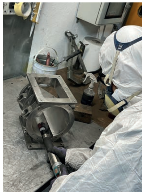
De productie is voor een belangrijk deel geautomatiseerd, maar vakmanschap - zoals hier het polijsten van de sluisen - blijft de basis.
