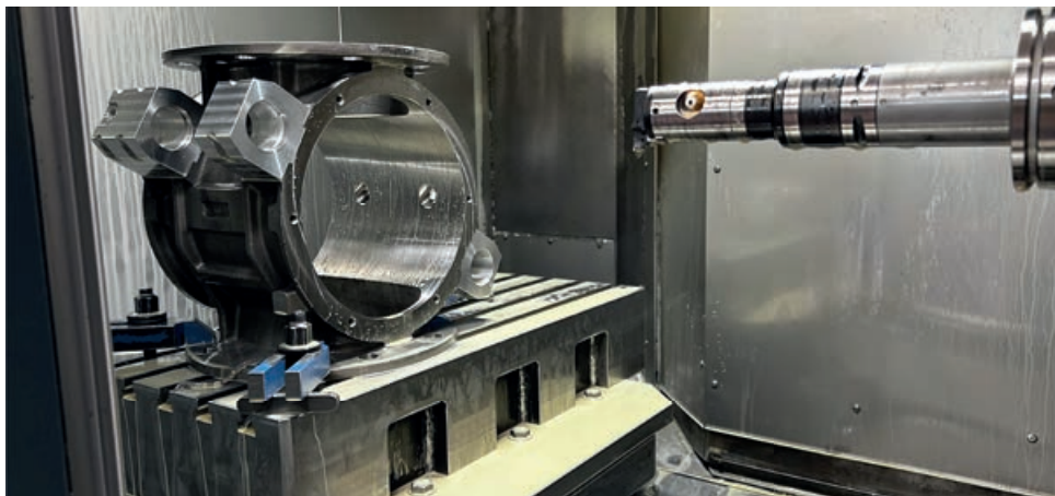
De productie van een SMD-huis in de CNC-machine van VDL Olocco.
